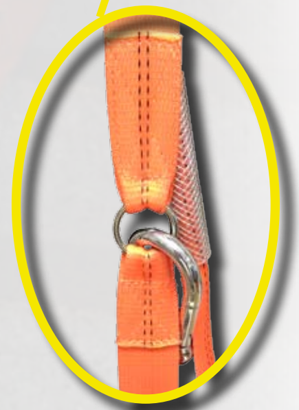
Detaillierte Abbildung des belasteten Teils ohne sichtbare Schäden
